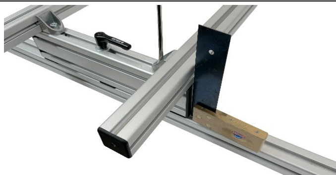
Abbildung 11: Querschienen bündig mit den Trägern auf den Längsschienen
