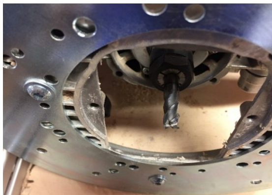
Abbildung 42: Fräswerkzeug, auch für Ausschnitte geeignet
