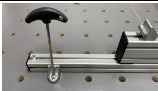
Abbildung 25: Längsschiene mit Träger montiert auf der Lochrasterplatte
