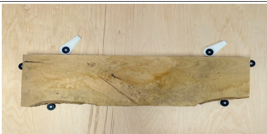
Abbildung 29: Befestigung eines Massivholzbrettes auf der Arbeitsplatte (beispielhaft)
