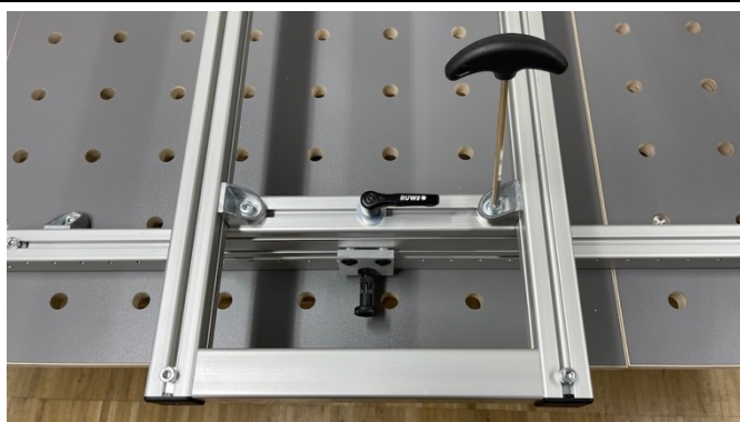
Abbildung 26: Querschienenrahmen mit den Längsträgern verbunden
