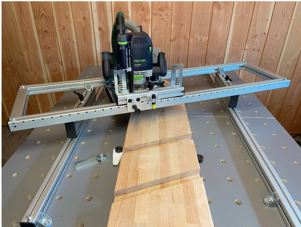
Abbildung 41: Bearbeiten von Treppenwangen
