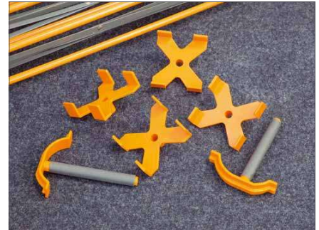
Zum Untergestell gehören zwei einfache Schnellspanner (T-förmig) und vier kreuzförmige Aufnahmen in die zum Beispiel Balken als Auflagefläche gelegt werden können
