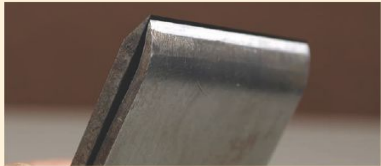
Nahaufnahme eines Spanbrechers mit Hobeisen – in dieser Anordnung sind beide in den Hobelkörper montiert.
