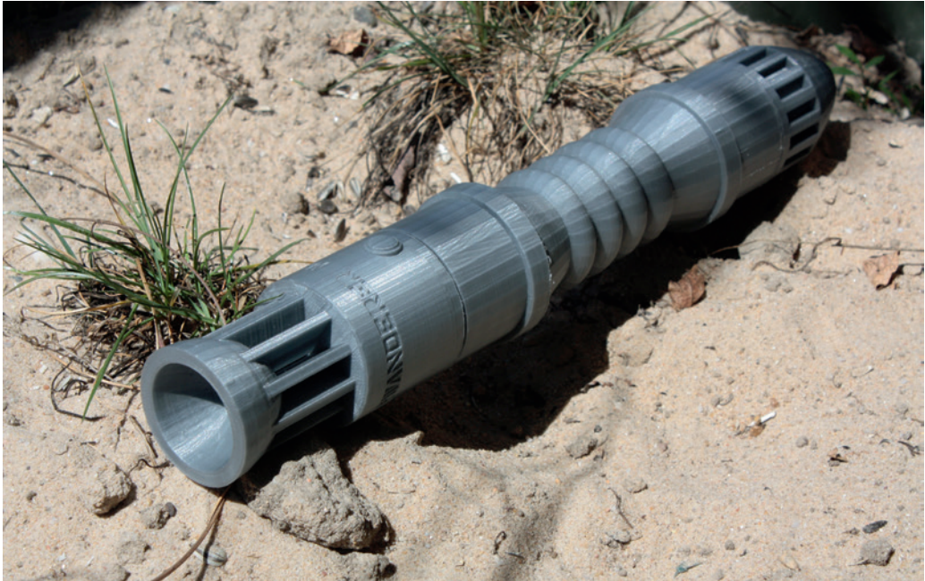
Bild 1.2 Auf Basis von Tinkercad entsteht der Griff eines Laserschwerts mithilfe der direkten Modellierung von Basiskörpern.
