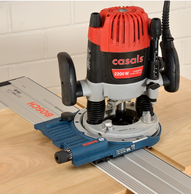
Interessant ist der Adapter vor allem für Besitzer der Casals CT 3000 (oder Freud FT 3000), die nun problemlos auf beiden populären Schienensystemen betrieben werden kann. Links im Bild die Casals auf dem Bosch/Mafell-Schienensystem und rechts auf dem Festool-kompatiblen Schienensystem.
