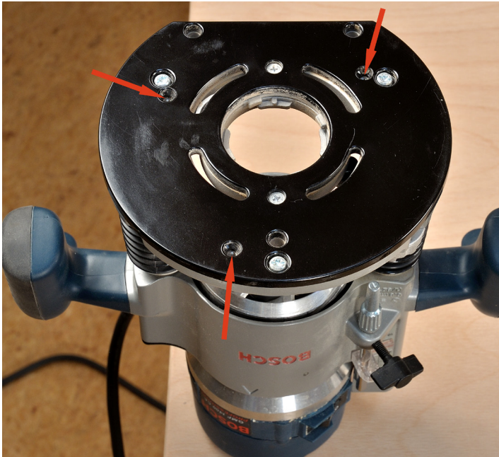
Kunststoffplatte nicht entfernen! Drei M4er Gewinde (Pfeile) sind für die Befestigung mit M4 x 12 mm Gewindeschrauben vorgesehen. Löcher im Adapter mit der Markierung „A“ verwenden (s. Pfeile Bild unten).
