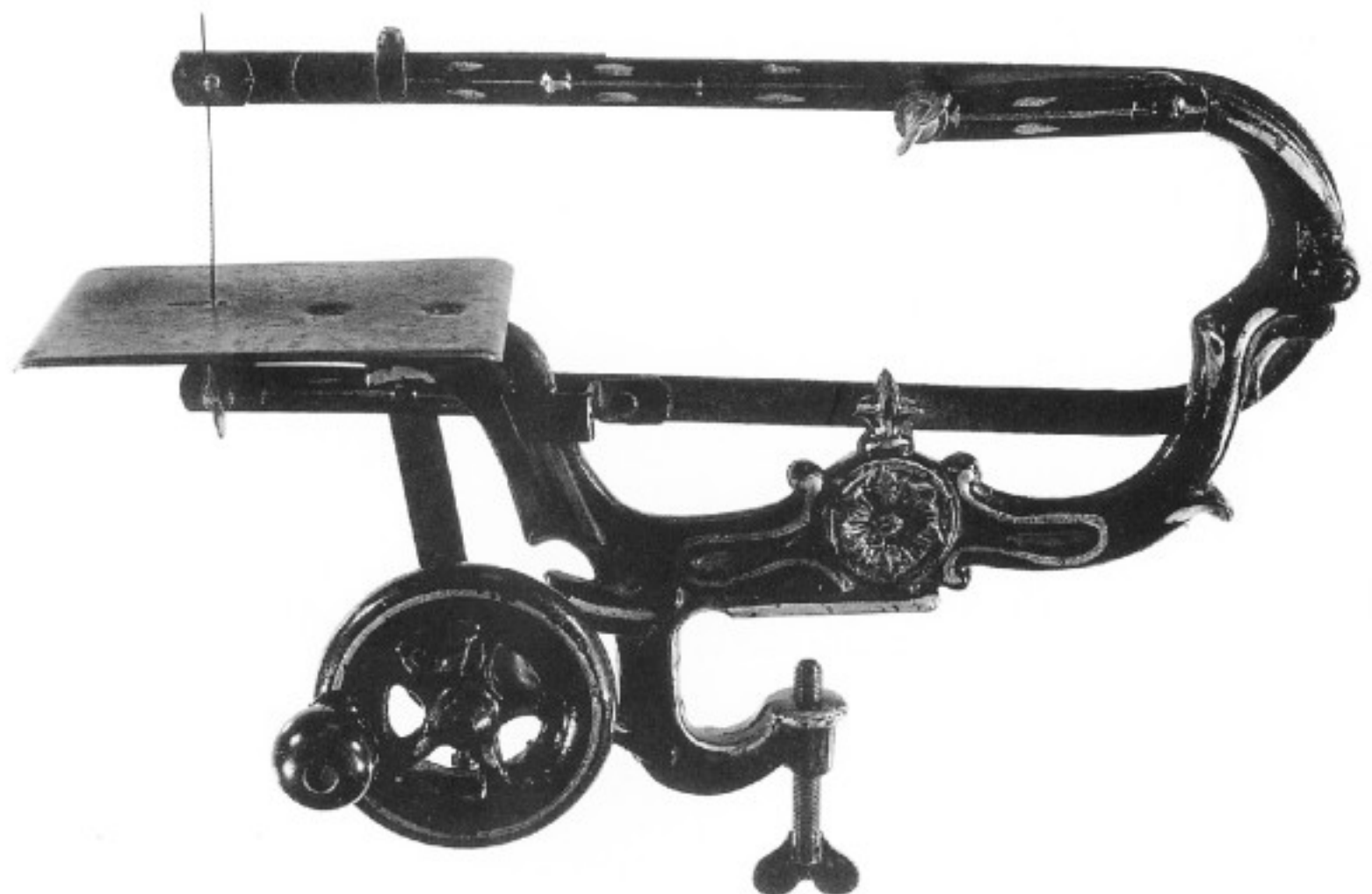
Diese mechanische Laubsäge aus dem 19. Jahrhundert klemmte man am Tisch an. Das Sägeblatt wurde mit Hilfe einer Handkurbel auf und ab bewegt
