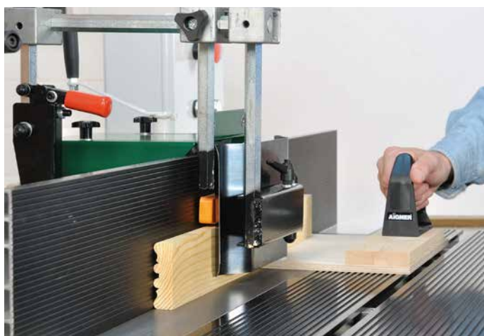
Üppige Profilierungen in nur einem Arbeitsgang sind die Domäne einer Tischfräse. Dabei können Sie nicht nur die Werkstückkanten, sondern auch (je nach Anschlaghöhe) Brettflächen bearbeiten.
