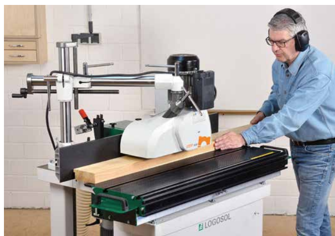
Durch den Einsatz eines Vorschubapparats steht der Serienfertigung nichts mehr im Weg. Der maschinelle Vorschub sorgt dabei nicht nur für gleichmäßige Fräsergebnisse, sondern bietet auch einen hohen Sicherheitskomfort.
