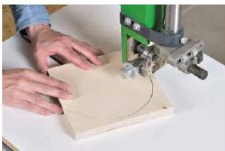
Wiederholgenaue und perfekt geformte Kreise gelingen auch auf der Bandsäge mit der entsprechenden Vorrichtung in wenigen Minuten.
