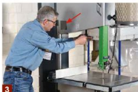
3 Im nächsten Schritt wird das Sägeband entspannt. Dazu drehen Sie die obere bewegliche Bandrolle mit dem Handrad soweit nach unten, bis die Spannungsanzeige im Sichtfenster (Pfeil) auf Null steht.
