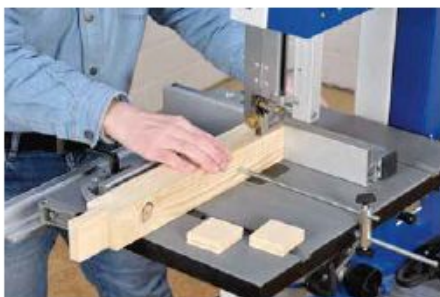
Auch klassische Holzverbindungen wie Schlitz und Zapfen können Sie auf einer Bandsäge im Nu präzise und wiederholgenau herstellen.
