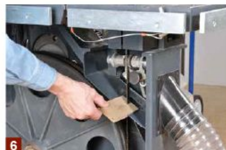
6 Nachdem Sie die Maschinentür geöffnet haben, finden Sie bei modernen Bandsägen ein solches geschlitztes MDF-Brettchen, das die Absaugleistung unter der Tischeinlage verbessert und die untere Bandrolle vor Staub und Spänen schützt. Auch dieses Brettchen muss entfernt werden.
