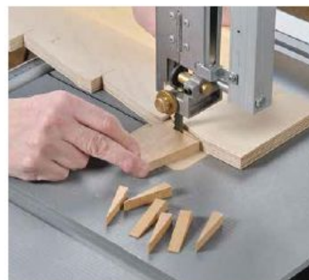
Selbst filigranste Werkstücke lassen sich auf der Bandsäge deutlich sicherer zuschneiden als auf jeder anderen Maschine.
