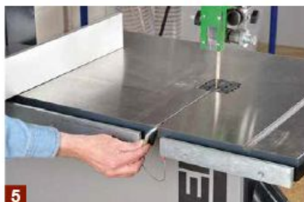
5 Der Säge Tisch ist an der Vorderkante bis zur Tischeinlage geteilt. Ein runder Stift in dieser Teilung sorgt dafür, dass die Tischfläche trotzdem plan und ohne Absatz verläuft. Er lässt sich zum Sägebandwechsel einfach herausziehen.
