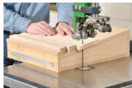
Einfach zu bauende Vorrichtungen (hier z. B. zum Aussägen von offenen Zinken) erweitern das Einsatzspektrum einer Bandsäge.
