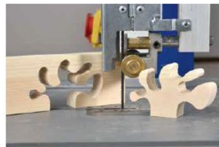
Die Bandsäge bietet immer eine perfekte Sicht auf den Schnittverlauf und liefert auch bei engsten Radien winkelgenaue Schnittflächen.
