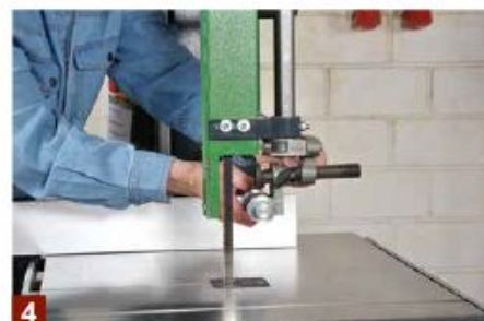
4 Anschließend schieben Sie die obere Sägebandführung komplett nach hinten vom Sägeband weg. Sie muss später sowieso noch auf das neue Sägeband eingestellt werden.
