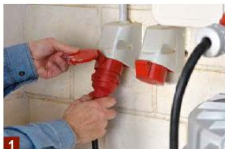
1 Sicherheit kommt an erster Stelle: Vor dem Sägebandwechsel immer den Netzstecker ziehen! Sollte das bei der Maschine nicht möglich sein, ...
