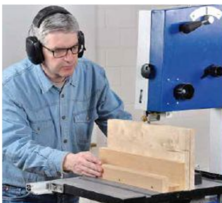
Das Auftrennen breiter Massivholzbretter bei geringstem Verschnitt ist die Königsdisziplin einer Bandsäge.
