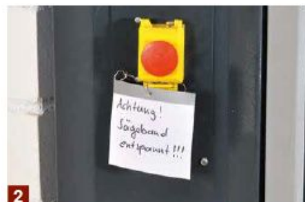
2 ... können Sie alternativ auch den Schalter so sperren, dass das Einschalten nicht mehr möglich ist (mit Hinweis Sägeband entspannt).
