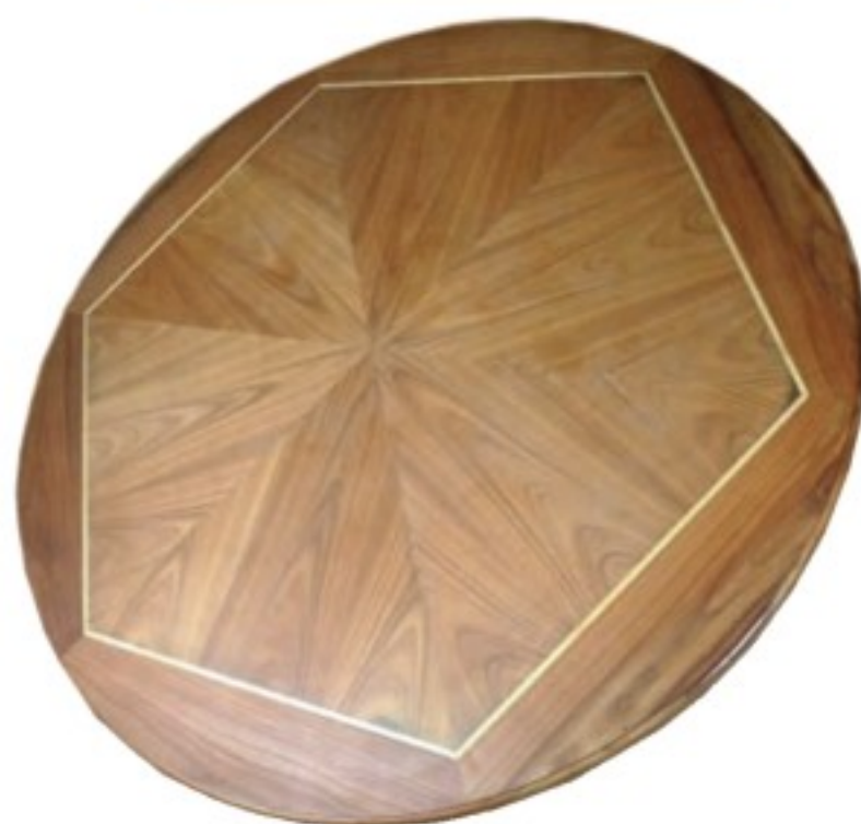
Tischplatte, aus sechs Furniersegmenten zusammengesetzt (Fotos: Designholz)
