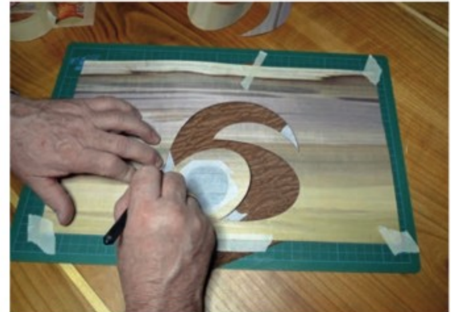
Das Einlagefurnier wird unter das Fenster gelegt und die Kontur mit dem Messer angeritzt.
