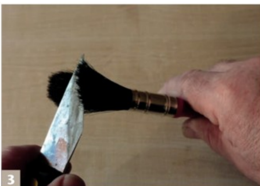
3 Schneiden von Pinselhaaren ist ein Vergleichsmodell, das zeigt, dass nur beim Schneiden mit der Faserrichtung (Schnitttrichtung mit den Haaren) ein sauberer Schnitt entsteht.
