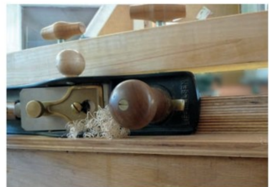
Die Furniere sind zwischen zwei Platten gespannt und werden mit dem Hobel „gefügt“.
