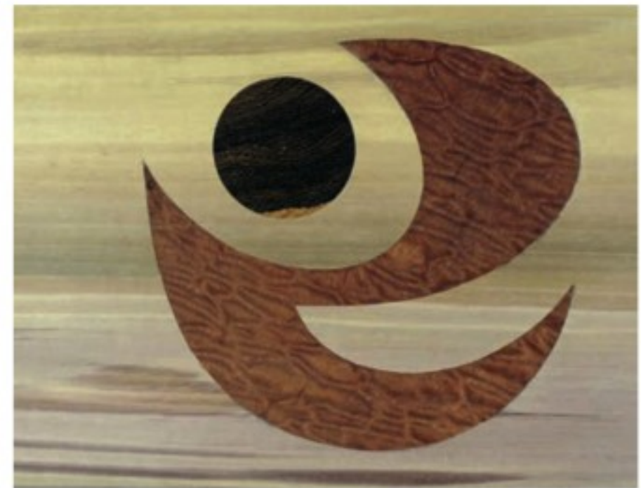
Die ausgeschnittenen Einlagen werden in das Grundfurnier eingepasst. Die Sichtseite liegt jetzt nach oben.
