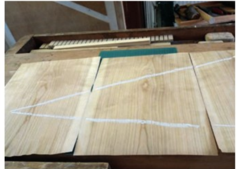
Das Furnierbild wird durch ein Schreinerdreieck mit Kreide gekennzeichnet.
