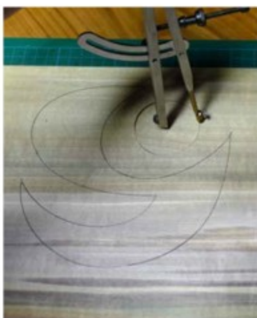
Mit dem Messer und einem Zirkel werden die Fenster ausgeschnitten.
