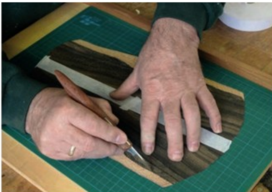
Mit dem Messer wird die Kontur entlang eines Jahresringes ausgeschnitten.
