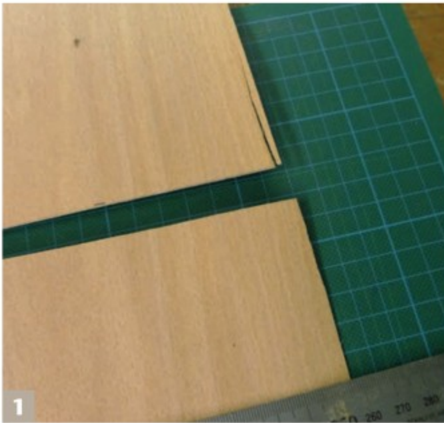
1 Beim Querschneiden eines Furniers ist die Gefahr besonders groß, dass sich das Holz an der Außenkante spaltet.
