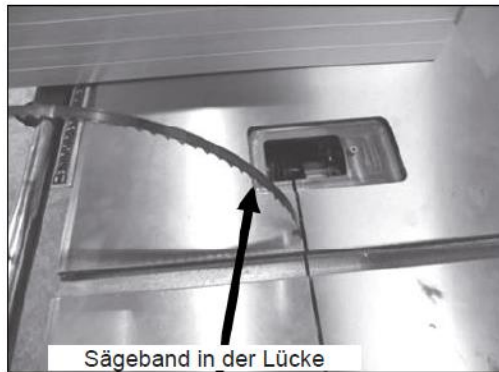
Sägeband in der Lücke – lame dans le fente Sicherheitsabdeckung – garde
