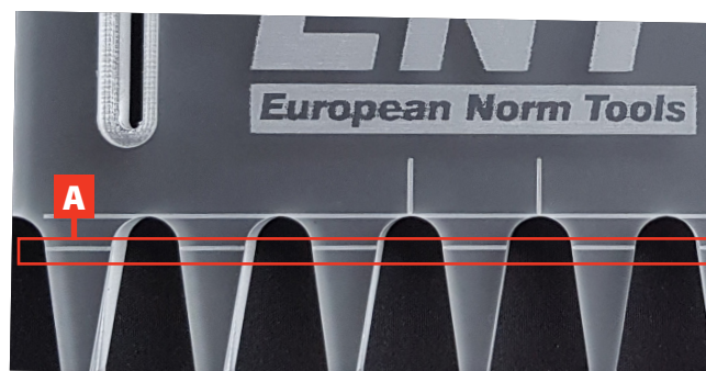
Abbildung 1.2: Werkstückpositionierung und Markierung mittels der horizontalen Mittelmarkierung auf der Schablone.
