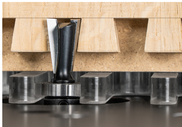
Abbildung 4: Der Anlaufring läuft beim Fräsen der Schwalbenschwanzzinken an der Schablone entlang.
