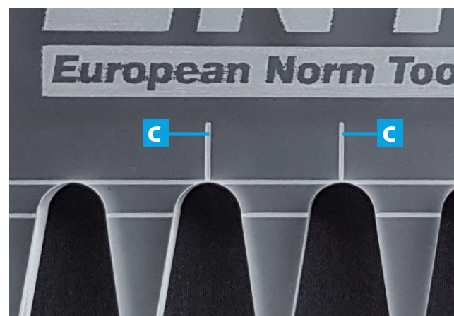
Abbildung 5: Werkstückpositionierung und Markierung für das Konterprofil mittels einer der beiden vertikalen Hilfslinien.
