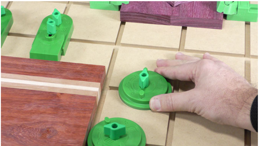
Fig 4a - Verwendung der Ring Clamps
