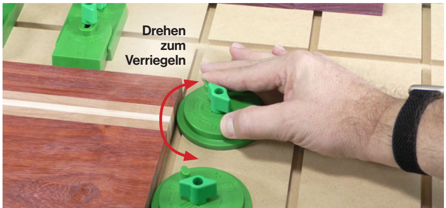
Fig 4b - Verwendung der Ring Clamps 2
