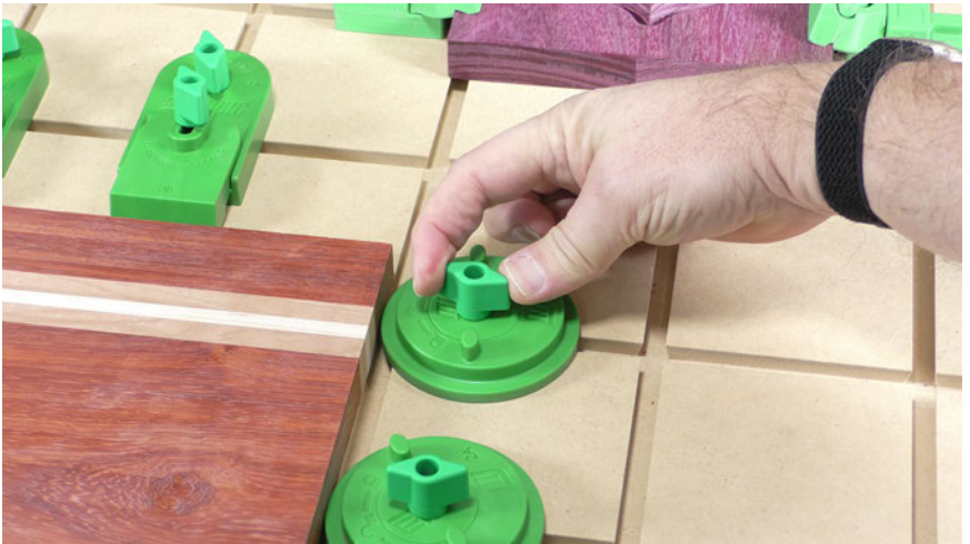
Fig 3c - Montage der Ring Clamp 2
