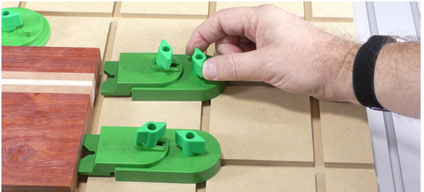
Fig 6a - Verwendung der Ramp Clamp
