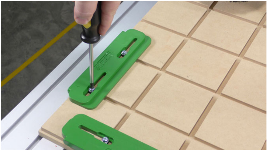
Fig 1b - Montage der Edge Guide
