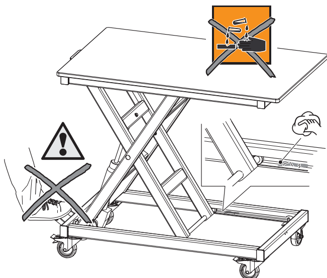
Abb. 7-1: Späne und Staub entfernen
