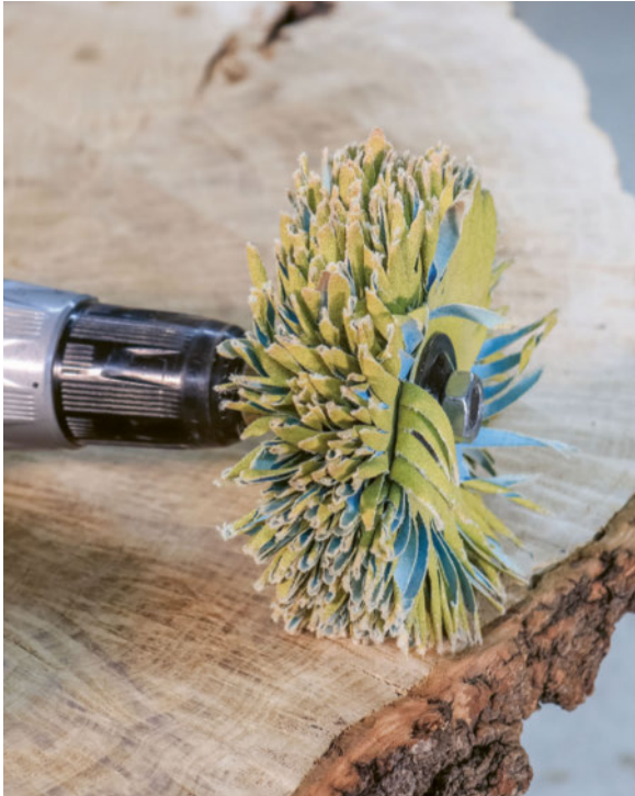
22 Ein Schleifmopp ist hervorragend geeignet, um Baumkanten zu säubern und glätten.
