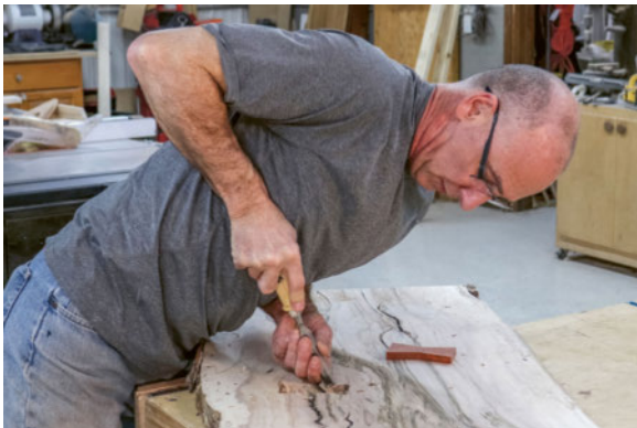
20 Versteifen Sie Ellbogen und Schulter, damit Sie sich auf den Stechbeitel lehnen können, um den Verschnitt abzustechen.
