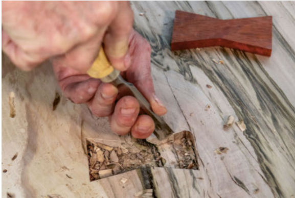
18 Eine gut gefräste Aussparung lässt sich leicht mit dem Stechbeitel verputzen.
