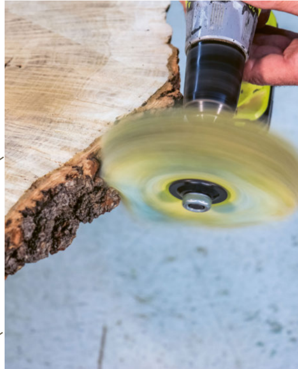
23 Setzen Sie den Schleifmopp in eine Bohrmaschine ein, und führen Sie ihn an den Kanten der Bohle entlang, um lose Stücke zu entfernen und scharfe Kanten abzurunden.
