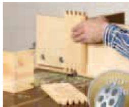
242 Fingerzinken auf dem Frästisch
