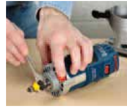
25 Kantenfräsen – die handliche Ergänzung zur Tauchfräse
