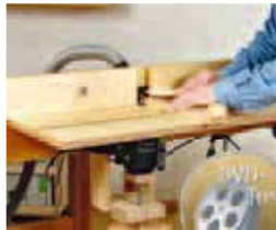
253 Mobiler Frästisch für die Hobelbank
