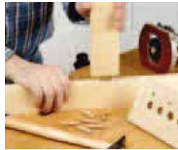
144 Runddübel mit der Oberfräse einbohren – die Dübelschab- lone
