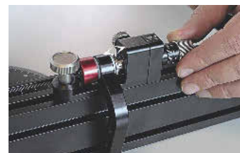
/ Der Kippanschlag gleitet in einer Nut und kann an jedem Punkt präzise arretiert werden.
