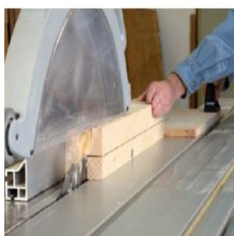
Müssen tiefe und breite Falze hergestellt werden, ist die Formatsäge genau das Richtige. Der Ab-schnitt kann sogar noch weiter genutzt werden.
