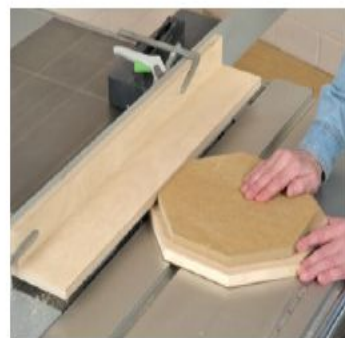
... aber auch das wiederholgenaue Kopieren zahlreicher Bauteile mithilfe einer Schablone, sind nur einige der vielen Anwendungsmöglichkeiten.
