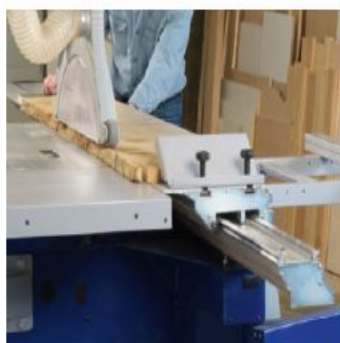
Die Formatkreissäge ist ein universelles Arbeits-tier. Grobe Zuschnitte wie beispielsweise das Besäumen von sägerauen Brettern und Bohlen ...
