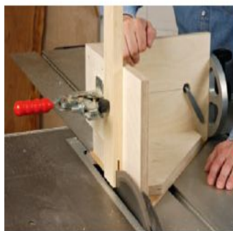
Mit einfachen selbst gebauten Vorrichtungen und Hilfsmitteln können Sie das Einsatzspektrum deut-lich erweitern. Schlitz- und Zapfenverbindungen, ...
