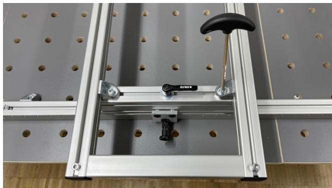
Abbildung 26: Querschienenrahmen mit den Längsträgern verbunden
