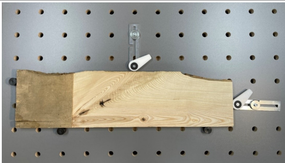
Abbildung 30: Befestigung eines Massivholz Brettes auf der Lochrasterplatte
