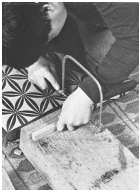
Nachdem man mit einem Handbohrer ein Loch in die Zunge des Streichmaßes gebohrt hat, steckt man ein feines Laubsägeblatt hindurch, befestigt den Bügel der Säge und sägt so den Schlitz für das Messer.
