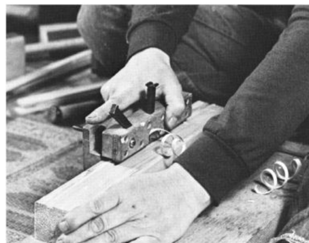
Zum Aushobeln von ganz schmalen Nuten wird der kikai-shakuri-kanna (Maschinen-Nuthobel) benutzt.
