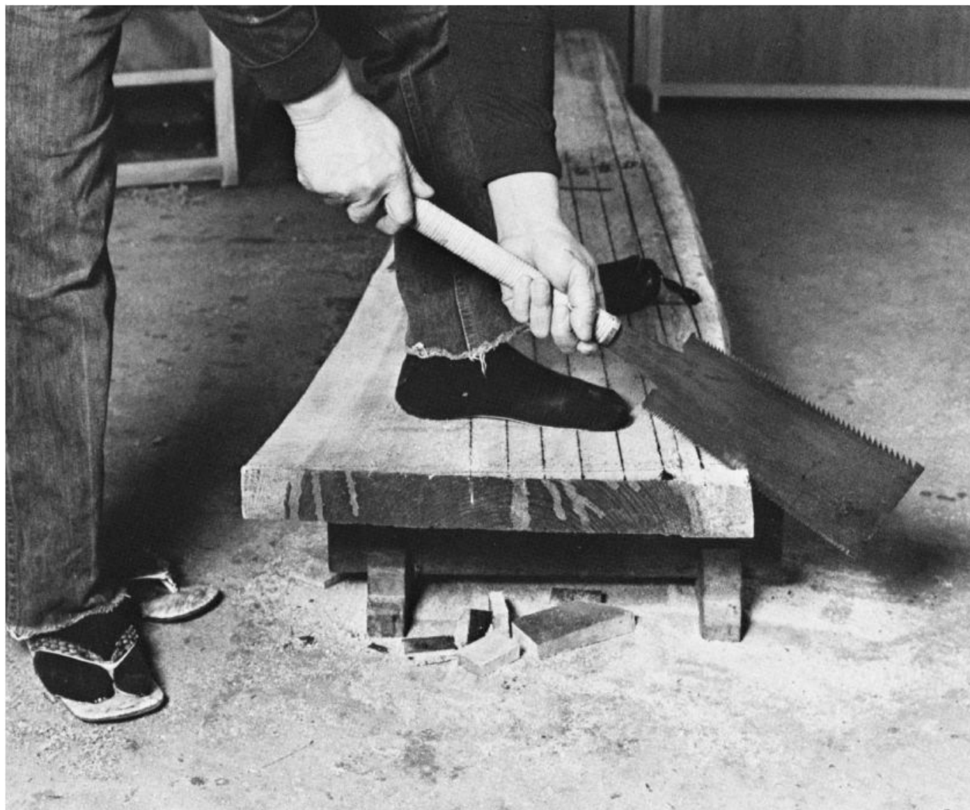
Beide Hände liegen weit auseinander am Sägegriff. So haben Sie mehr Kraft und Kontrolle über die Säge.
